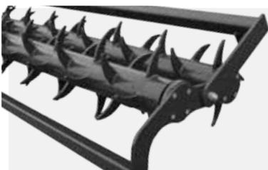
Diese Walze mit Durchmesser 500mm mit Hydraulik eingestellt, verwendet bei schweren und schwermittleren Boden. Diese Walze dient zum Boden zerkleinern und entfernen von Rest der Pflanzen. Das ermöglicht Anhalten der höheren Bodenfruchtbarkeit, als auch hilft bei besserer Filtrierung der Boden. Diese Walze macht eine Bewässerung auf Tiefe 15 cm
