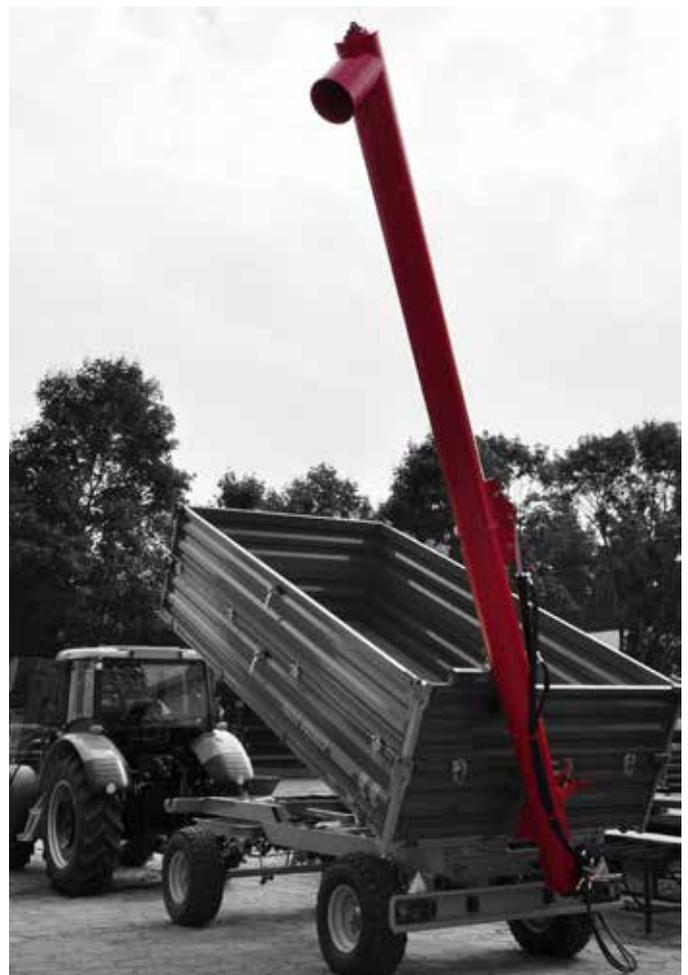
\* Die Leistung des Schneckenförderers hängt von der Feuchtigkeit und dem Verschmutzungsgrad des Kornes sowie vom Neigungswinkel zur Plattform (zum Anhänger) ab.
