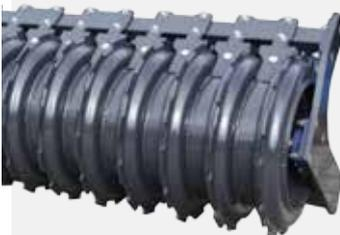
Es ist eine Packerwalze mit scharfen Graten, durch die der Boden bis in eine größeren Tiefe konsolidiert wird. Diese Walze krümelt sehr gut die Bodenklumpen, das große Gewicht der Walze drückt die Steine in den Boden. Sie eignet sich für schweren und steinigen Boden mit einer großen Menge an organischer Masse. Diese Walze ist mit Schabern ausgestattet. Die Walze verfestigt den Boden streifenförmig: verbessert den Austausch von Wasser und Luft im Boden.
