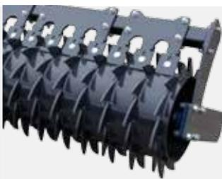
Ideal für jede Bodenart. Die Walze verfestigt den Boden streifenförmig: verbessert den Austausch von Wasser und Luft im Boden. Die Walze wird für den steinigen, feuchten Boden mit einer großen Menge an organischer Masse empfohlen. Die Walze schafft ideale Bedingungen für die Aussaat. Eine universelle Walze. Die Walze verfügt über Reinigungsschaber aus gehärtetem Borstahl.
