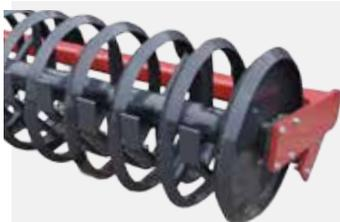
Der Vorteil dieser Walze ist, dass sie dank der konischen Ringe den Boden besser krümelt und verfestigt. Die Schleppe zwischen den Ringen ebnet den Boden und reinigt den Zwischenraum zwischen den Ringen. Die streifenförmige Verfestigung lässt mehr Wasser in den Boden eindringen. Die beste Wahl für trockenen, schweren Boden.
