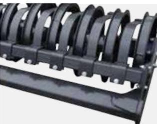
Eine schwere Walze, die ein sehr gutes Krümeln und Packen des Bodens gewährleistet - streifenförmige Verfestigung des Bodens. Die Walze eignet sich für schweren und feuchten Boden. Zwischen den Ringen der Walze befindet sich die Ackerschlepe, die die Walze reinigt und das Feld ebnet.
