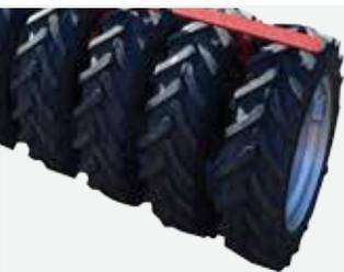
Die Walze besteht aus Reifen (185/65/15 4PR). Diese Walze findet doppelte Anwendung: die erste ist die Verdichtung des Bodens und die zweite ist der Transport der Maschine, die sich auf der Walze stützt. Dies ermöglicht das Ankoppeln der Maschine an Schlepper mit geringer Leistung.
