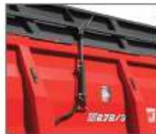
Senk- und Hebeoption des hydraulischen Aufsatzes. Steuerung aus der Schlepperkabine.
