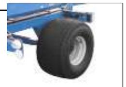
Die breiten Räder 26,5-14,00-12 verringern die Bodenpressung bei der Arbeit.
