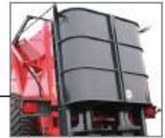
Hintere Abdeckungen mit Spanndraht direkt am Arm der hinteren Riegel befestigt, wodurch sie sich automatisch öffnen.
