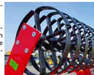
Flexringwalze Zur tiefen Verfestigung mit der lockereren Bodenoberfläche. Walzenelemente werden aus Federstahl hergestellt. Dadurch kann die Walze den durch die Arbeitselemente bearbeiteten Boden einebnen. Dank den Federelementen ist die Walze zur Selbstreinigung fähig. Sie kommt sogar bei schwersten Bodenverhältnissen zurecht.
