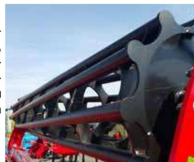
Rohrwalze ermöglicht eine in Bezug auf Arbeitsqualität entsprechende Tiefenführung der Bodenbearbeitungsgeräten. Die Walze eignet sich gut zur Einebnung und Rückverfestigung der Bodenoberfläche auf leichten und mittleren Böden. Die Walze krümelt auch größere Bodenschollen. Sie zeichnet sich durch niedrige Wartungskosten sowie niedriges Gewicht aus.
