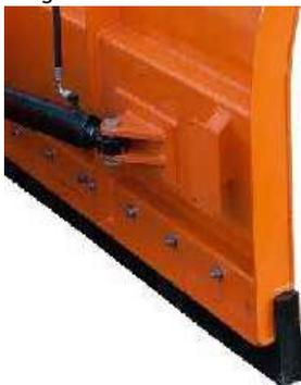
Feder beim Auffahren auf ein Bordstein, Gullideckel oder auf ein anderes Hindernis und klappt zurück. Diese Lösung dämpft zuerst den Aufprall auf ein im Schnee verstecktes Hindernis mit der Höhe bis 120mm, ändert dann den Angriffswinkel der Schürflieiste und gleitet über das Hindernis herüber.
