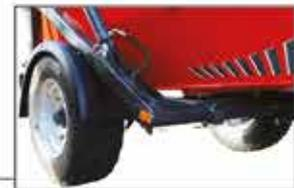
Bereifung 385/65 R22,5 ermöglicht Arbeit in feuchten und Torfgebieten.
