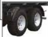
Tandemfahrwerk auf parabolischen Federn.
