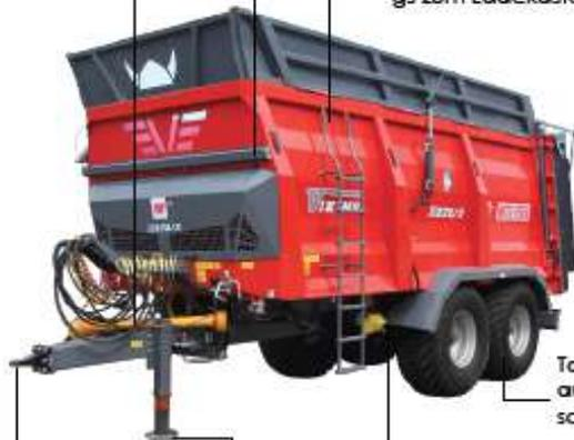
Tandemfahrwerk auf parabolischen Federn
