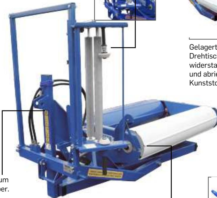
Die Sicken auf den Trommeln des Ballenwicklers verbessern die Widerstandsfähigkeit der Maschine und verhindern Ballenrutschen.
