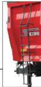
Steigleiter zur Erleichterung des Zugangs zum Ladekasten.
