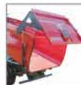
Hinterklappe, hydraulisch aufklappbar.
