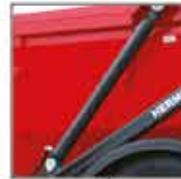
Zwei hydraulische Zylinder bewirken Neigung des Anhängerkastens.
